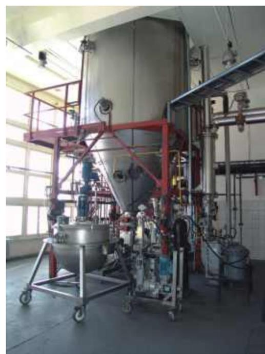
Установка сушки смесей распылением HC-120 фирмы "Niro Atomizer"
