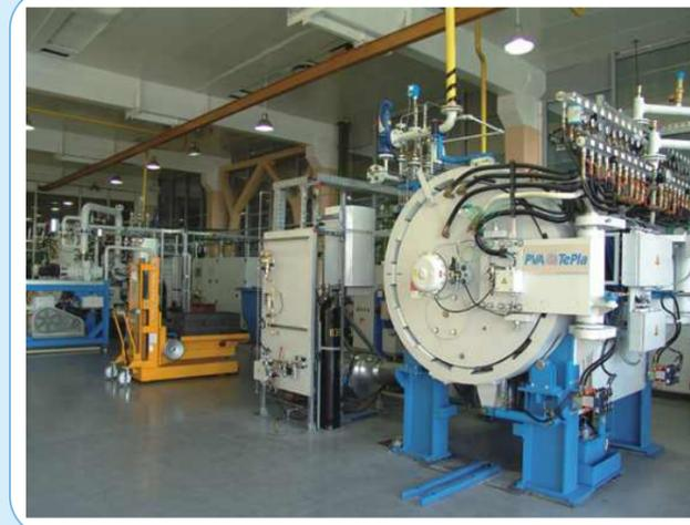
Печь вакуумно-компрессионного спекания фирмы "ALD Vacuum Technologies AG"
