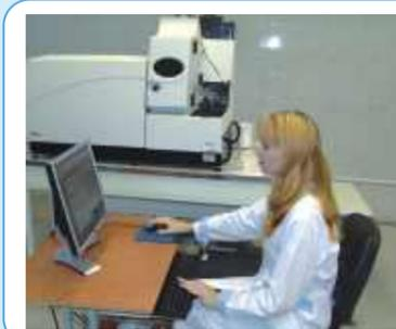
Современный масс-спектрометр фирмы "Thermo" с чувствительностью на уровне ppt
