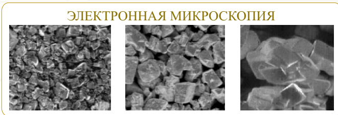
Микроструктура порошков вольфрама (1), триоксида вольфрама (2), паравольфрамата аммония (3), полученная на электронном микроскопе фирмы "Tesla"
