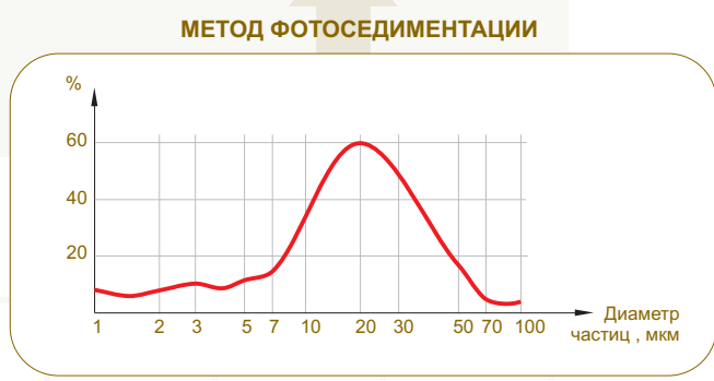
Распределение масс частиц триоксида вольфрама, полученное с помощью фотоседиментографа.
